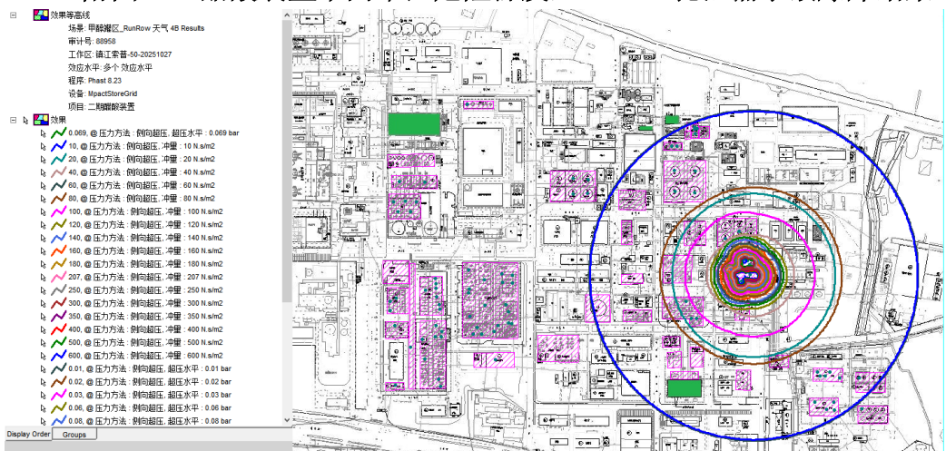
附图 7-6 二期醋酸装置危险源发生 50mm 孔泄漏事故爆炸结果
